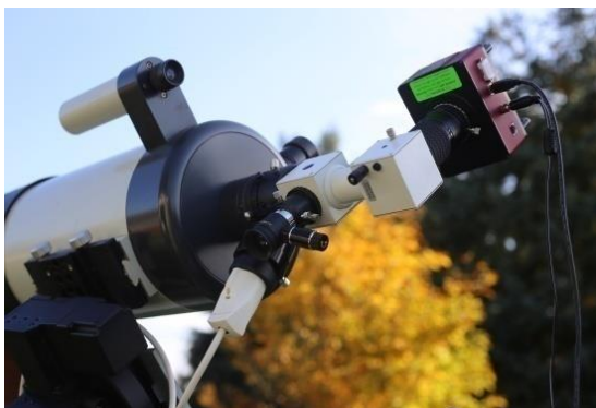
Abb. 2: Zeiss-Meniscas 180/1800 mit DADOS-Spektrograf und CCD-Kamera STF 8300 M sowie Ne-Kalibrierlampe.
