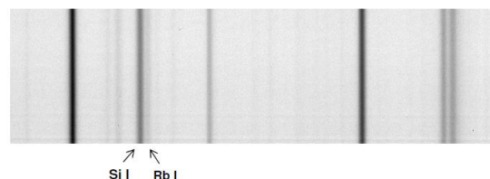
Abb. 5: Gemitteltes und mit Dark und Flat korrigiertes 2D - Spektrum.
