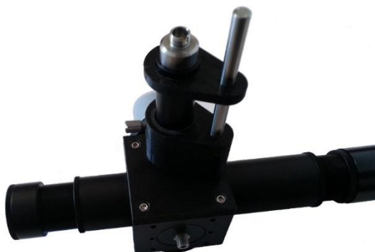
Abb. 2: Die Faserkopplungseinheit bildet zusammen mit dem Faserbündel die IFU für MIFUS.
