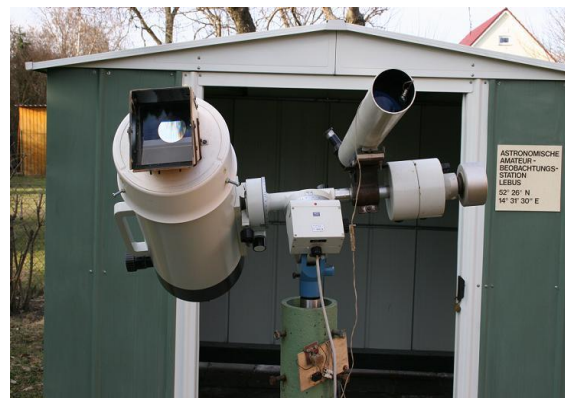
Abb. 3: Objektivprismenspektrograph Meniscas 180/1800 mit 45°-Objektivprisma BK 2.
