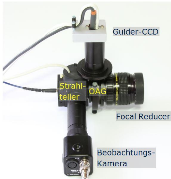
Abb. 10: Gesamter Fiberport mit Strahlteiler, Beobachtungskamera, OAG, Guider-CCD und Focal Reducer.
