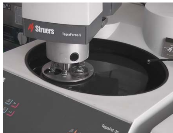
Abb. 12: Eingegossener Meteorit bei der Probenpräparation.
