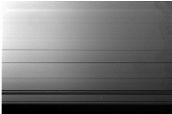
Abb. 3: Flat mit deutlich mehr Staub als Abb. 2, rechts zusätzlich Schlieren vom Deckglas der CCD.
