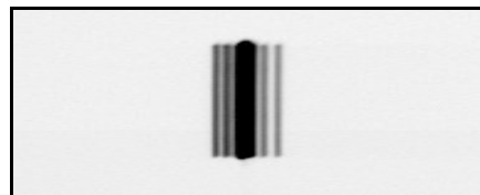
Abb. 13: Feinstruktur der Hg – Linie bei 435,8 nm
